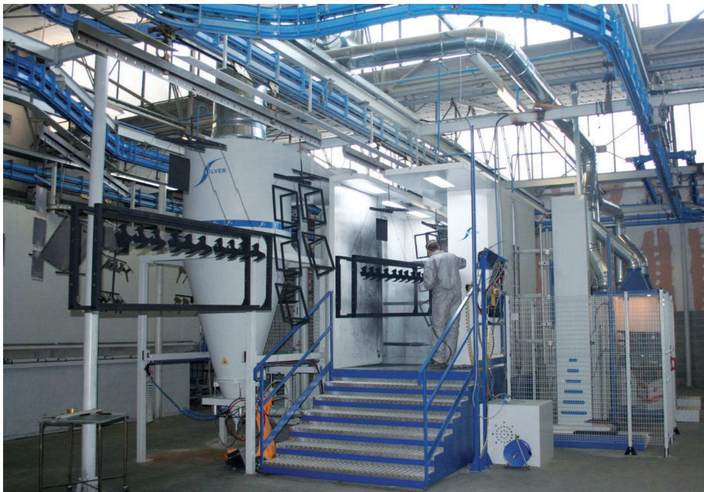
2 – L'impianto è stato recentemente rinnovato sostituendo tutta la fase applicativa (cabina, pistole, centro colore), ora di Siver Nordson. Comprende, oltre alla cabina, il nuovo centro colore Top Color Change Dual che utilizza la tecnologia airless "in fase densa" (HDLV Technology), le nuove pistole automatiche e manuali per il ritocco.
