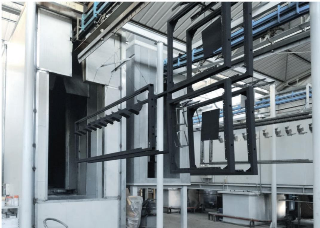
notevole di polveri. Il trasportatore invia al forno di cottura ad aria calda i pezzi verniciati (fig. 14) fino al raffreddamento e allo scarico.
