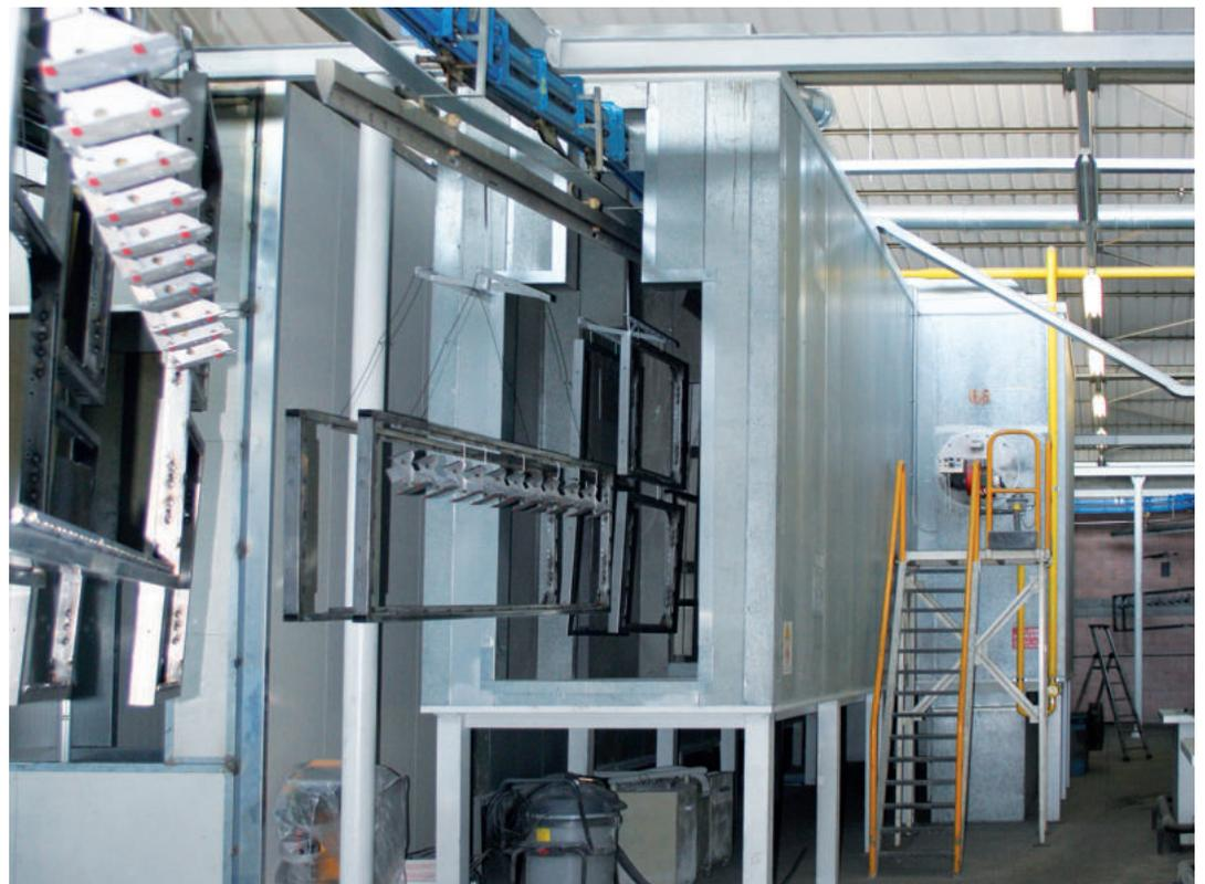
nostadio, una vera innovazione della Chemetall – le cui operazioni sono tutte gestite da software dedicato (automazione di controllo quantitativo di erogazione della soluzione, del pH, dell'acqua di risciacquo, del consumo energetico e altro ancora: fig. 9), porta al forno di asciugatura e da qui (fig. 10) alla cabina di erogazione polveri (figg. 11 e 12), con il cambio colore
