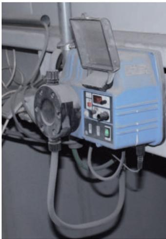
**9 – La centralina che rileva lo stato dei prodotti di pretrattamento inviando i dati al software che gestisce in automatico quantità, pH e tutti i parametri utili.**
