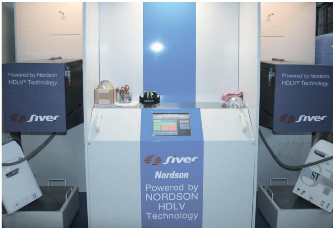
*13 - I due contenitori delle polveri, uno in uso, l'altro pronto per sostituirlo in meno di 90 secondi.*
