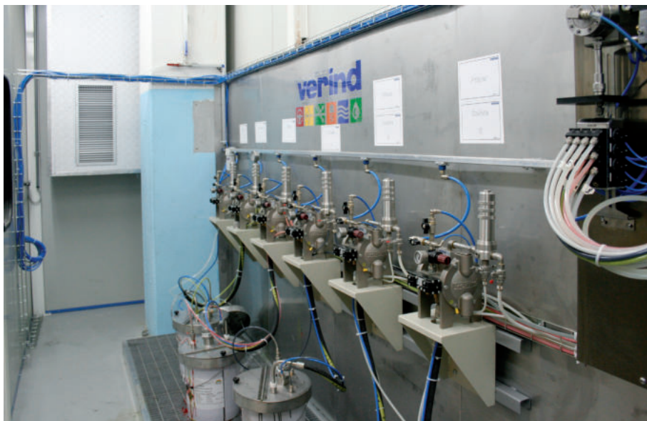
23 – L'impianto di verniciatura pezzi fuori standard fino a 3.000x2.000xh2.000 mm.
