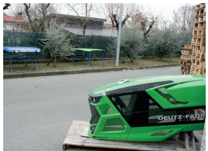
18- Alcuni pezzi verniciati posizionati all'esterno per verifica delle condizioni di durata.
