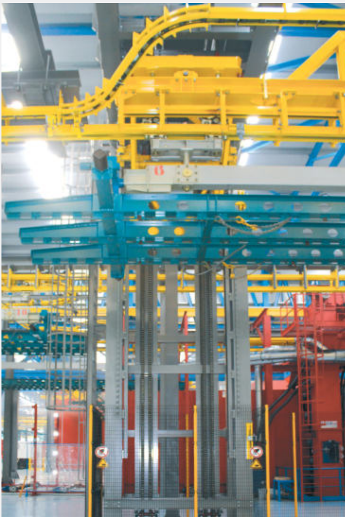
8 – Ascensori e discensori sono dotati di doppia catena, ciascuna caratterizzata per sostenere tutto il peso in caso di rottura di una di esse. Élévateurs et descenseurs équipés avec double chaîne, chacune apte à soutenir tout le poids en cas de rupture de l'un des deux.
