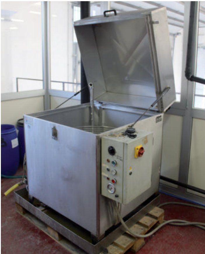
13 - La macchina di lavaggio pezzi per sottoporli poi a verniciatura
