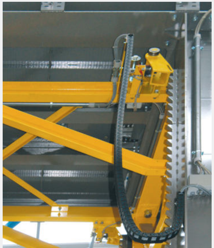
9 - Nel caso di rottura di entrambe le catene, entrano in funzione i freni meccanici, comandati da elettromagnete. I freni meccanici sono, a loro volta, controllati da sensori.
