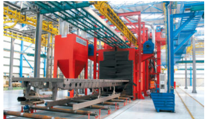
14 – Un telaio all'uscita dalla granigliatrice. La sua barra (e relativa sottobarra) di trasporto aereo segue il telaio che trasporterà nelle fasi che seguiranno.
