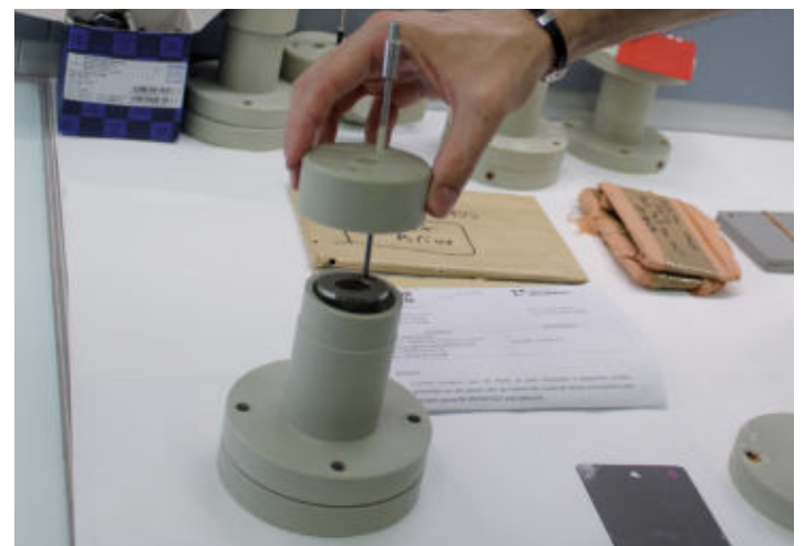
méthode Acet), pour les essais de résistance à la corrosion en seule 24 heures
