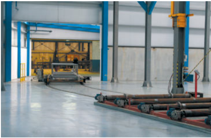
9 e 10 – L'ingresso al reparto di verniciatura dei telai dei rimorchi avviene mediante veicolo elettrico. Il telaio è supportato da una slitta che passa sulla rulliera della linea granigliatura e trasporta il telaio attraverso la macchina granigliatrice.
