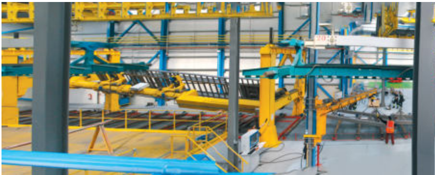
13 – La linea granigliatura. Per i telai dei rimorchi termina con una stazione di manipolazione di ciascun telaio (a sinistra), che facilita le operazioni di eliminazione di tutti i residui di graniglia e depolverazione.
