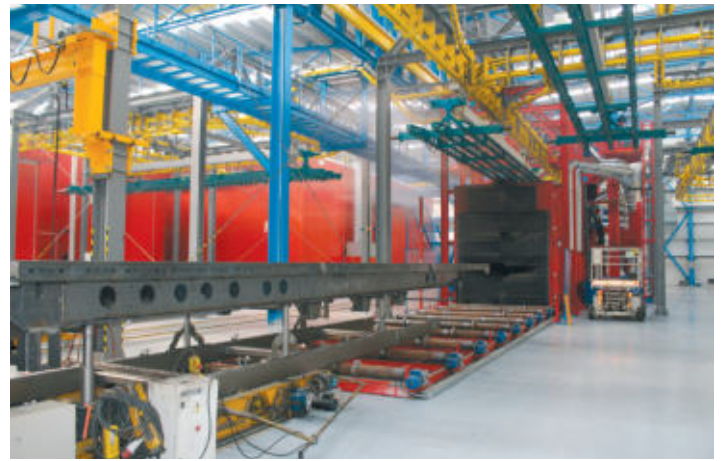
L'entrée des châssis des remorques est effectuée à travers un véhicule électrique. Le châssis est placé sur une courroie transporteuse qui passe sur les rouleaux de la ligne de grenailage et il le transport à travers l'enceinte de grenailage.
