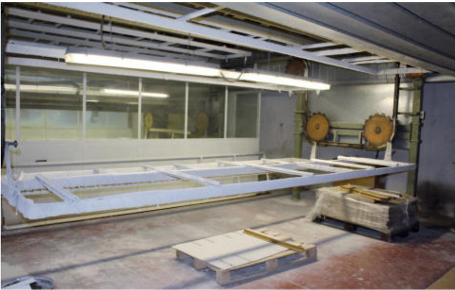
9 e 10 - Una delle due zone dedicate alla verniciatura della produzione, dotata di due impianti a carosello e da una linea di verniciatura automatica per la finitura di pezzi standard.
