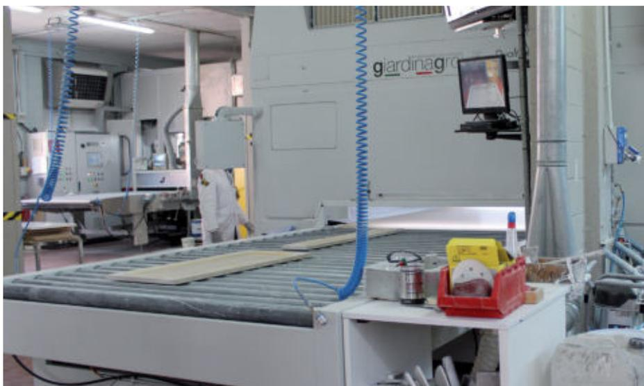
10, 11 - La spruzzatrice a bracci oscillanti viene utilizzata per l'applicazione del fondo all'acqua.
