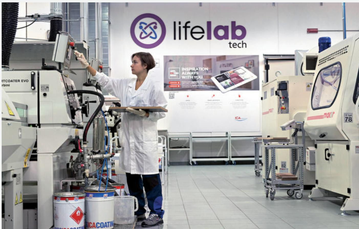
4 – Il Life Lab Tech è lo spazio dove sono allestiti impianti di tipo industriale per l'applicazione delle vernici, dove si effettuano prove interne e dove si procede con l'applicazione e la messa a punto dei cicli per i clienti, utilizzando le migliori tecnologie applicative tradizionali e nuove, come l'essiccazione con lampade ad eccimeri.
