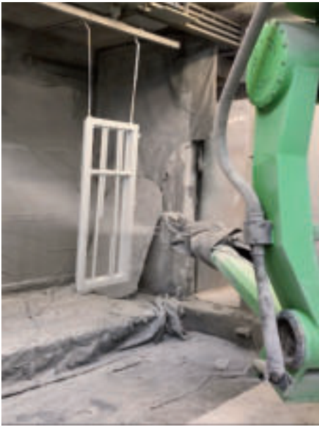
6 – Robot antropomorfo per finiture laccate in azione.
