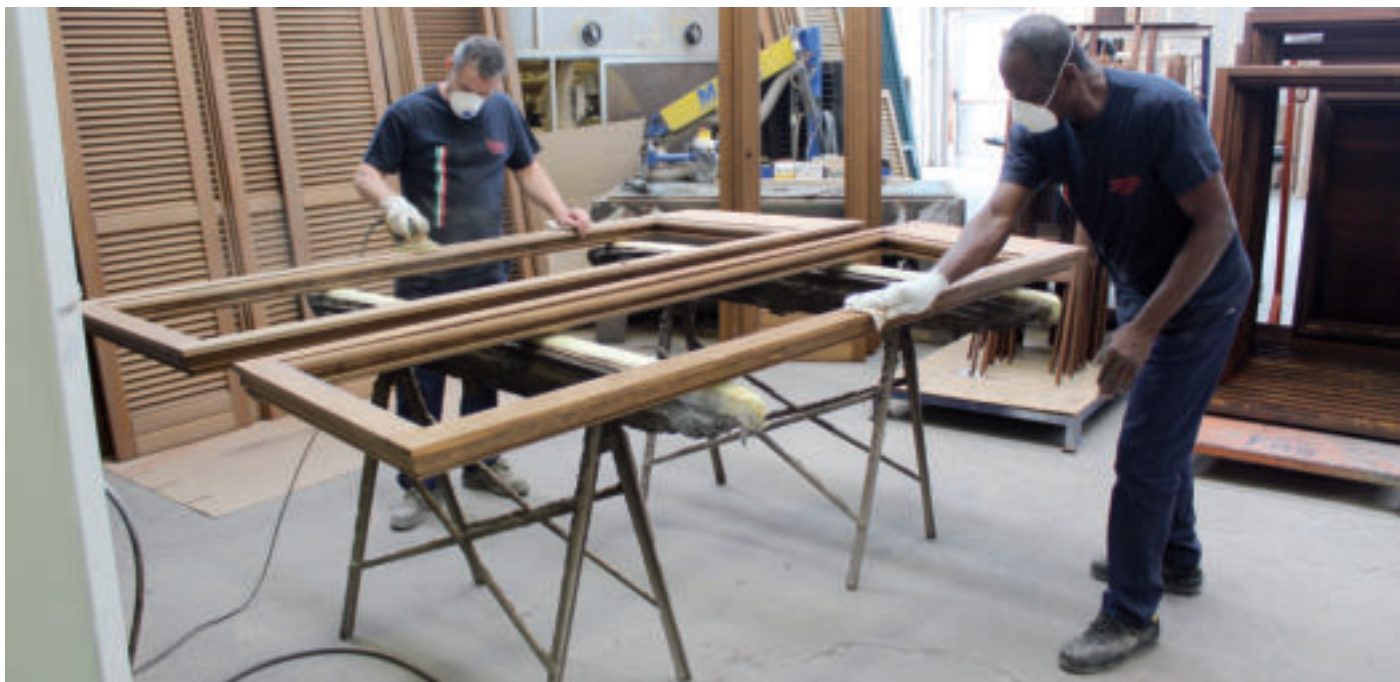
1 – Levigatura di serramenti, i pezzi vengono preparati per le operazioni di restauro.
