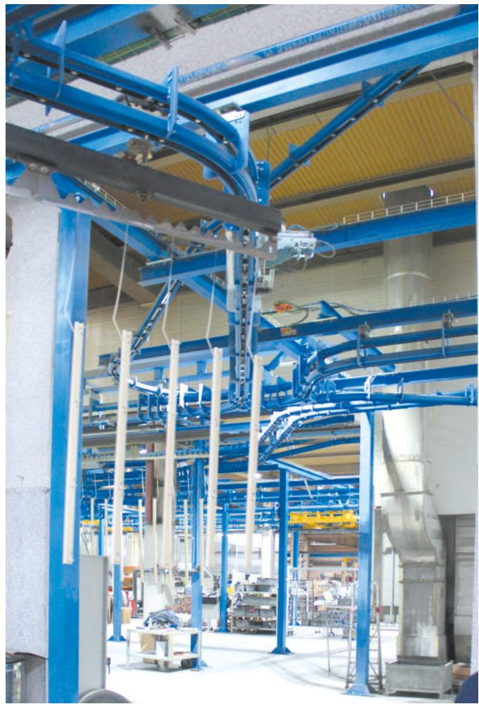
**10 – Dal polmone di raffreddamento all'uscita dal forno d'asciugatura verso l'incrocio con l'anello dei cicli bistrato. Il programma gestisce gli accessi alla zona d'applicazione, in funzione della configurazione della cabina.**
