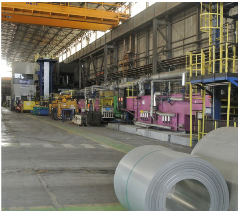
1 – Il reparto di verniciatura del coil nella sede Liberty Magona di Piombino, in provincia di Livorno. L'azienda è attiva dalla fine dell'ottocento. In foto si vede uno dei due impianti di verniciatura, quello con pretrattamento ad immersione.
