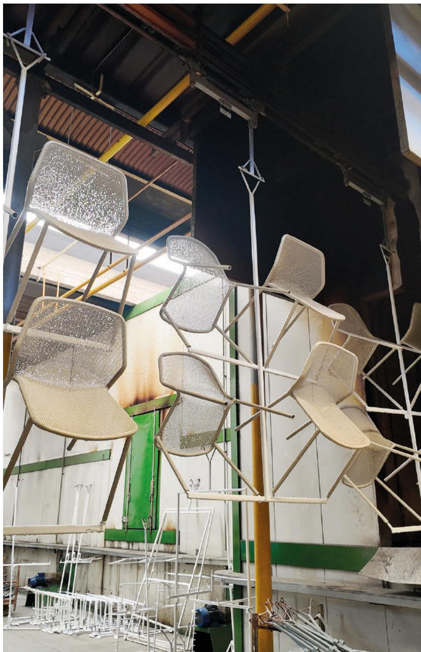
**8 – Le attrezzature d'appensione sono progettati e realizzati in funzione dei pezzi da trattare per ottimizzare il processo d'applicazione automatica e facilitare l'accesso per il ritocco manuale.**
