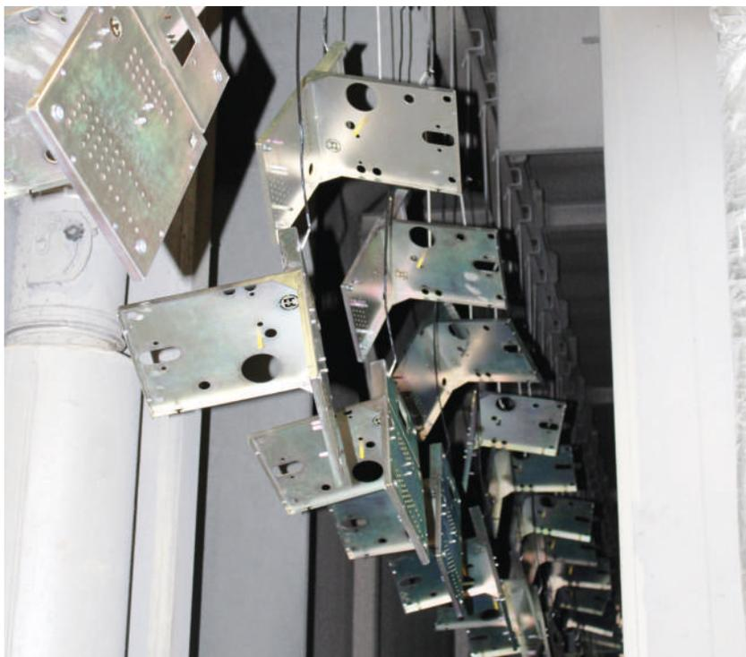
**4 e 5 - I pezzi entrano nel tunnel di pretrattamento, con conversione nanotecnologica, che a breve verrà implementato con la tecnologia Bonderite E-CO Flex di Henkel, un controllo interconnesso dei parametri del processo di pretrattamento.**
