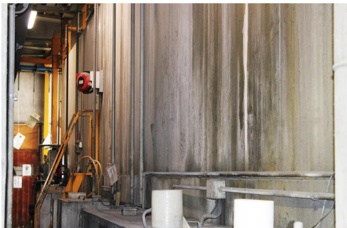
tunnel di pretrattamento con *Bonderite E-CO flex* di Henkel, un sistema di monitoraggio e di dosaggio dei prodotti in continuo (*online*), che permette una riduzione significativa del controllo effettuato offline e a un incremento della qualità, poiché i parametri, controllati automaticamente, risultano costanti nel tempo.
