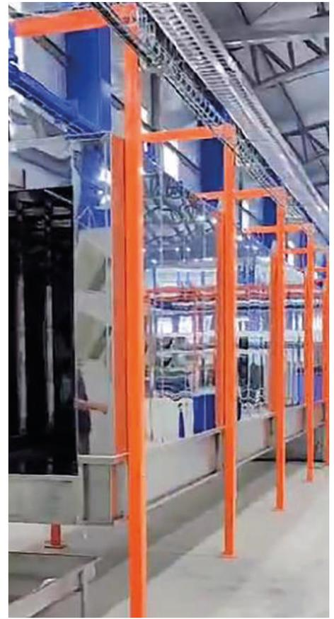
**4 – L'interno del tunnel di pretrattamento per il processo Toran 3 Chemtec. Prevede un'unica fase di asperzione a bassa pressione, e il ricupero dell'eccesso mediante sgocciolamento. È anidro, permette così a Inselec di azzerare i consumi d'acqua e il trattamento dei reflui. Stabile nel tempo, ha più che raddoppiato le resistenze alla nebbia salina dell'intera produzione dell'azienda.**
