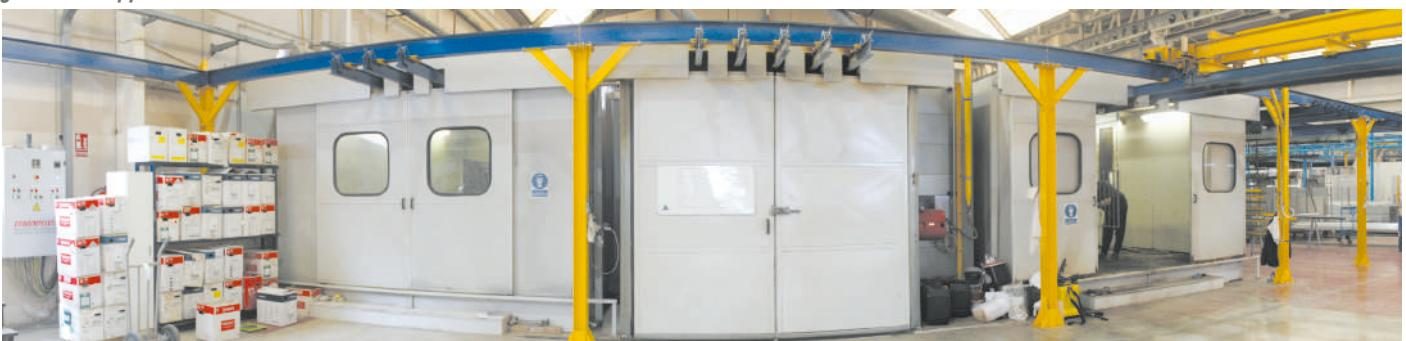
**9 – Da destra, la cabina di preparazione delle superfici, il forno d'asciugatura/polimerizzazione e la cabina d'applicazione polveri dell'impianto Combi.**
