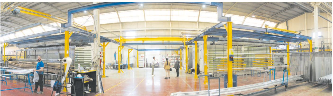
**10 – Vista generale dell'impianto Combi di Euroimpianti. Il sistema di trasporto permette la massima flessibilità d'uso di cabine e forno. Le barre portapezzi si spostano lungo l'impianto e i polmoni d'accumulo con un sistema ad azionamento manuale assistito da motore, per facilitare il lavoro dell'operatore.**
