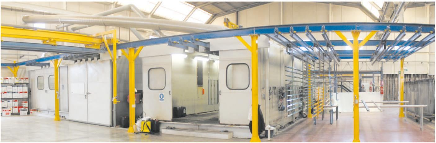
**8 – L'impianto Combi, semiautomatico, consente l'applicazione di tutti i cicli necessari, mono o bistrato, metallizzati, testurizzati, su qualsiasi superficie metallica, ferrosa o non ferrosa. Le dimensioni e il sistema di trasporto permettono di trattare profili, lamiere e pezzi di grande sviluppo tridimensionale.**
